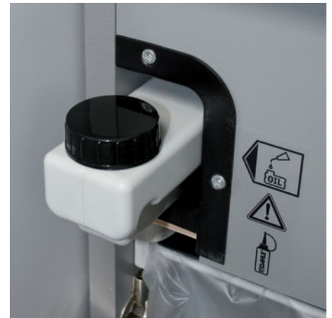
Встроенный маслобак для регулярной автоматической смазки дисковых ножей перекрестного измельчения продлевает срок службы при постоянных нагрузках
